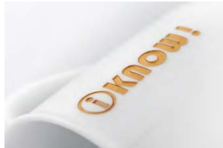
Barwienie hydroglazurą piaskowanego motywu Hydroglazing of sandblasted motif
