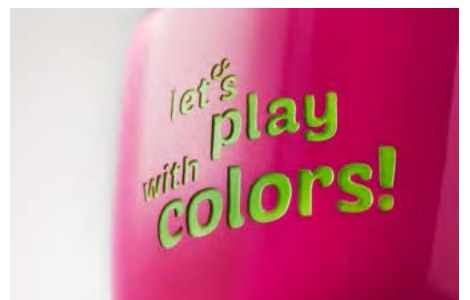
Hydroglazura + barwienie piaskowanego motywu Hydrocolor + hydroglazing of sandblasted motif
